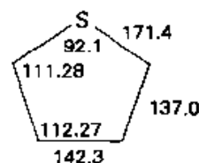
图 5.4 噻吩的结构 (键长: pm, 键角: 度)
